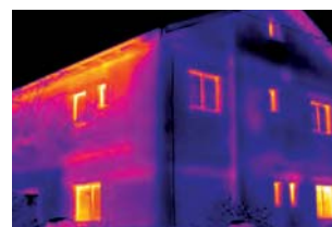
Vyhledání energetických ztrát budov: okamžité rozpoznání a zobrazení tepelných mostů na fasádách nebo v budově.
