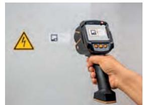
**3.** V termokameře testo 883 aktivujte průvodce testo SiteRecognition.
