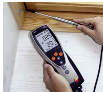
testo 435 – přístroj pro měření proudění vzduchu u netěsného okna
