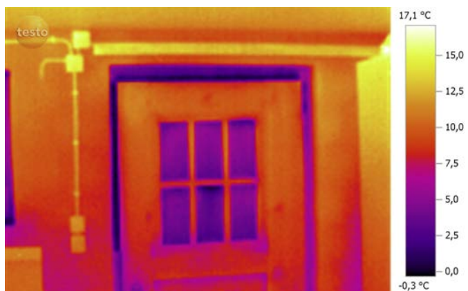
Netěsné dveře: Zobrazení vad izolace dveří
