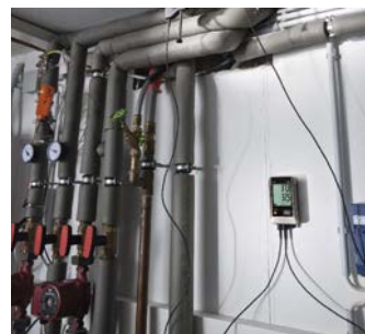
testo 175-T3 – měření diferenční teploty stoupačky a vracečky
