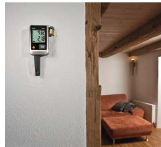
testo 175-H2 – měření teploty a vlhkosti v místnosti
