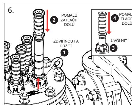
6. Vraťte magnety do provozní pozice tak, že zdvihнete a podržíte šedý zamykací prstenec a začnete pomalu tláčit magnet dolу. Uvolněte zamykací prstenec a pokračujte v zatlačování magnetu dokud se nezajistí v provozní pozici. Opakujte tuto proceduru se všemi magnety.
