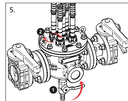
5. Až z filtru začne vytékat čistá voda tak uzavřete vstupní ventil a poté uzavřete i vypouštěcí ventil. Uzavřete odvzdušňovací ventil.
