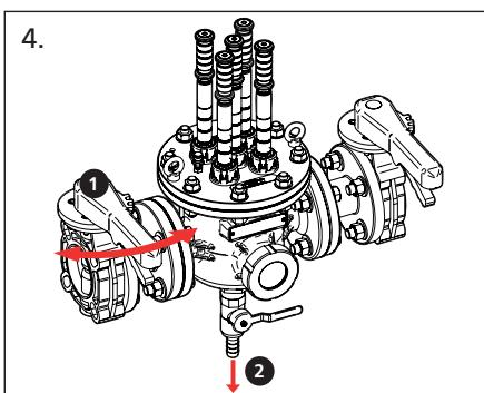
4. Částečně pootevřete vstupní ventil, výstupní ventil ponechte uzavřený a tím vypláchnete zbytek nečistot z filtru.
