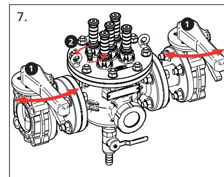
7. Otevřete vstupní a výstupní ventily filtru, doplňte tlak v systému na požadovanou hodnotu. Odvzdušněte filtr pomocí odvzdušňovacího ventilu. Ujistěte se, že se do jímek magnetů nedostala žádná voda a že jsou suché. Odstraňte případné zbytky tekutin z vršku filtru.
