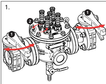
1. Zkontrolujte průzor na boku filtru MagnaClean pro kontrolu stupně zanesení. Vypněte zdroj tepla a odpojte jej od přívodu elektriky. Uzavřete ventily na obou stranách filtru a poté otevřete odvzdušňovací ventil navrchu filtru.
