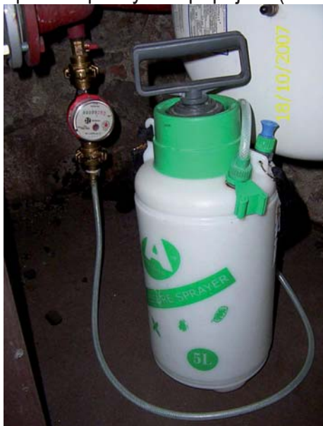
Obrázek č.15 Zapojení pro stanovení velikosti úniku média
