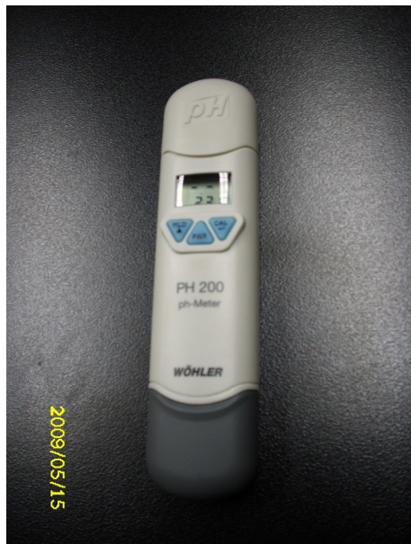
Obrázek č. 3 Elektronický pH metr, sloužící ke stanovení pH zkoumaného roztoku.
