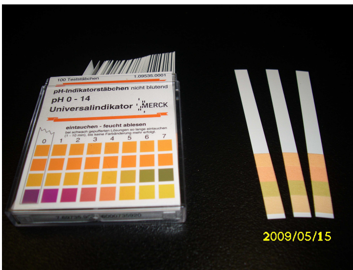
Obrázek č. 2 pH papírky sloužící ke stanovení pH zkoumaného roztoku. Na krabičce je uvedena barevná stupnice pH, podle které se určuje pH.
