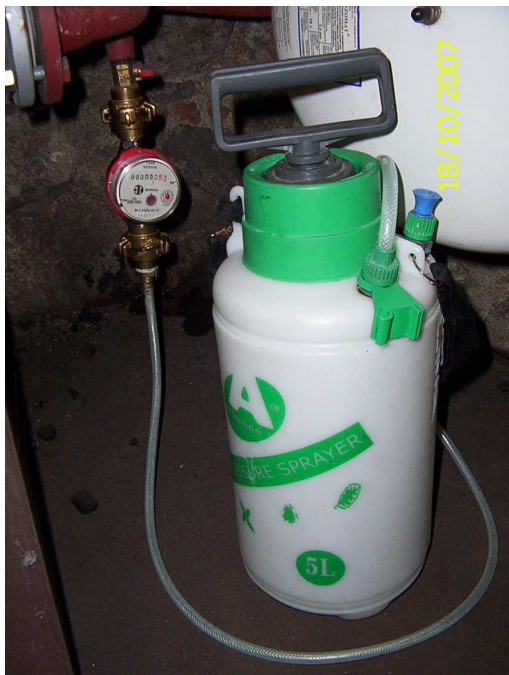
Obrázek č. 1A Upravený zahradní postřikovač, slouží jako tlaková plnicí nádoba ( do 3barů, podle druhu postřikovače). Na postřikovači se seřízne hadice s originální koncovkou a nahradí se např. hadičníkem s bajonetovou rychlospojkou, Nyní je postřikovač upravený pro snadné připojení. Mohou být využity i jiné koncovky a redukce na vodu. Na napouštěcím kohoutu je namontovaná bajonetová rychlospojka s vnitřním závitem.
