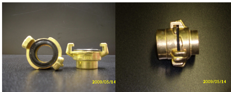
Obrázek č. 4 Bajonetové rychlospojky, tyto spojky lze využít ke snadnému připojení tlakové plnicí nádoby a topného systému. Lze využít i jiné spojky na vodu.
