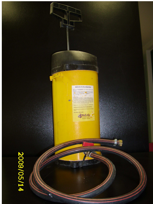
Obrázek č.1 Tlaková plnicí nádoba-vysokotlaká (do 8barů).
