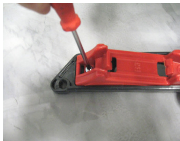
4) Upevňovací prvky přišroubujte pomocí přibalených šroubků k držáku.
