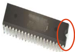
Označení na mikroprocesoru (vybrání na straně)
