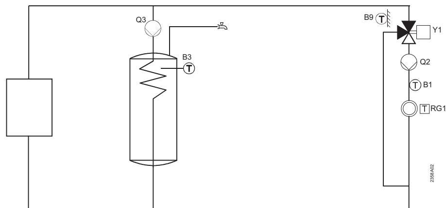
Příprava TV s přepouštěcím ventilem
