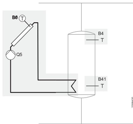
Nabíjení zásobníku a bazénu přepouštěcím ventilem s 1 solárem
