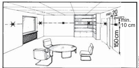
Při umístění prostorového přístroje v hlavním obytném prostoru je vhodné přihlédnout k následujícím skutečnostem:
