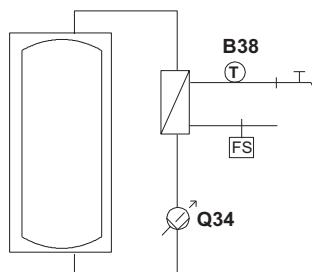
Když průtokový spínač (FS) detekuje průtok, čidlo B38 zajistí udržení aktuální jmenovité žádané teploty TV (rádek 1610). Když průtokový spínač zjistí, že není žádný průtok, je vypnuto čerpadlo Q34.
