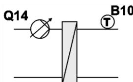
Otáčky jsou sníženy, pokud teplota na B10 překročí žádanou hodnotu.
