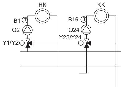
Chladící a topné okruhy odebírají chlad / teplo z oddělených okruhů.
