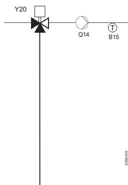
Předregulátor umožňuje dosáhnout nižší nebo vyšší teploty náběhu pomocí směšovacího ventilu, aby byla dosažena teplota náběhu pro zóny vytápění / chlazení podle žádané hodnoty, která je vyšší nebo nižší než teplota společného náběhu.
