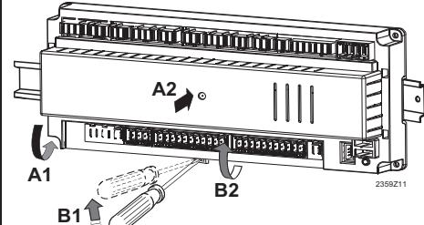
A: Montáž / B: Demontáž
