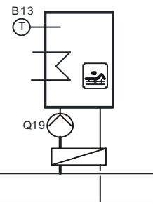
Regulátor řídí ohřev bazénu pomocí solární energie nebo zdrojem tepla podle samostatně nastavitelných žádaných hodnot. V případě solárního vyhřívání je možné zvolit prioritu ohřevu bazénu před nabíjením zásobníku.
