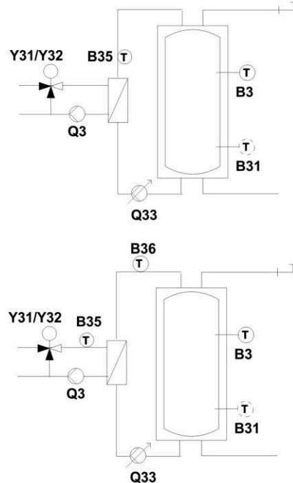
Tepelný výměník mimo zásobník, se směšovačem meziokruhu.
