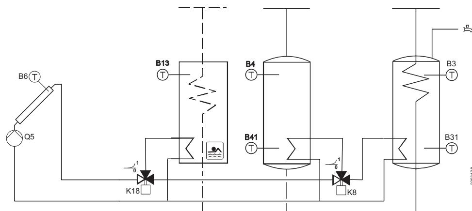
Nabíjení zásobníku a bazénu přepouštěcím ventilem s 2 soláry
