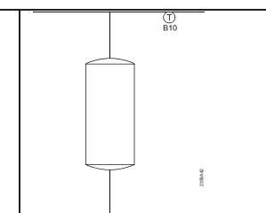
Pokud je teplota snímána čidlem společného náběhu (B10 za akumulací) a klesne pod teplotu zdroje o více než nastavený rozdíl teplot, průtok vody na straně spotřebiče je snížen pomocí blokovacích signálů (snížení žádané hodnoty). Pokud je blokovací signál 100% po dobu delší než 10 minut, je blokovací signál odstraněn a přepočítán po jedné minutě. Tím je zajištěno, že průtok vody na straně spotřebitele není nulový, protože by čidlem společného náběhu B10 neproudila voda.
