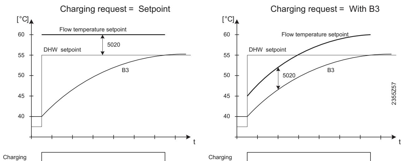
Porovnáním obou grafů je zřejmé, že v případě požadavku nabíjení "S B3" se plynule zvyšuje žádaná teplota (to samé platí pro "S B31").
