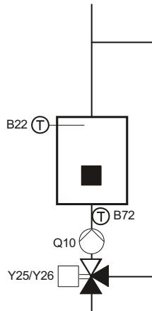
Při dostatečně vysoké teplotě kotle na dřevo je zapnuto čerpadlo kotle a je ohříván zásobník TV a / nebo akumulační zásobník.
