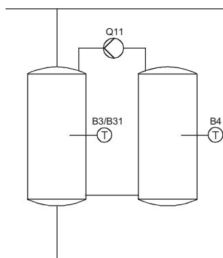
Pokud je teplota v akumulaci dostatečně vysoká, může být zásobník TV nabíjen z akumulace. V závislosti na hydraulickém spojení může být přenos tepla prováděn nabíjecím čerpadlem Q3 nebo přečerpávacím čerpadlem Q11, které je speciálně nastaveno pro tuto funkci.
