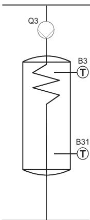
Regulátor reguluje teplotu TV podle časového programu nebo průběžně podle příslušné žádané hodnoty. Je možné nastavit prioritu ohřevu TV před vytápěním prostoru.
