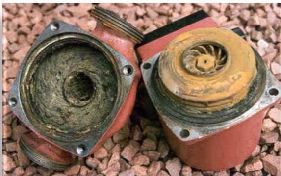
Typickým příkladem je zanášení čerpadla korozními kaly a jeho následné zablokování.
