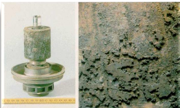
Typickým příkladem je zanášení čerpadla korozními kaly a jeho následné zablokování.
