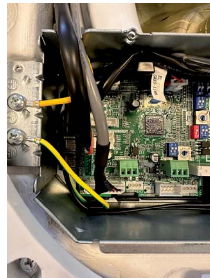
Detail konektoru pro připojení displeje a napájení pohybu lamel
