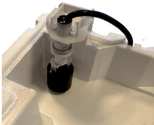
Snímač hladiny kondenzátu je umístěn na spodní straně polystyrenového těla
