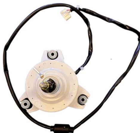
Motor ventilátoru je připevněn třemi šrouby
